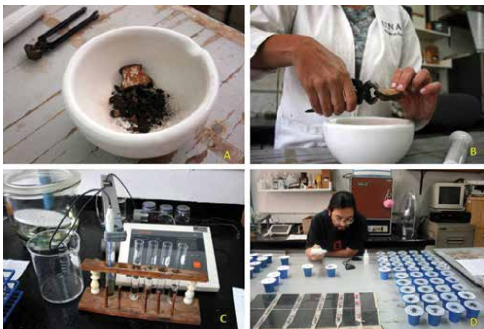
Figura 1.5 - Laboratório de Prospecção Arqueológica (UNAM) - A e B - Preparação da mostra - cerâmica moída no almofariz; C - Eletrodo para medir o pH da mostra; D - Análise de fosfato.
